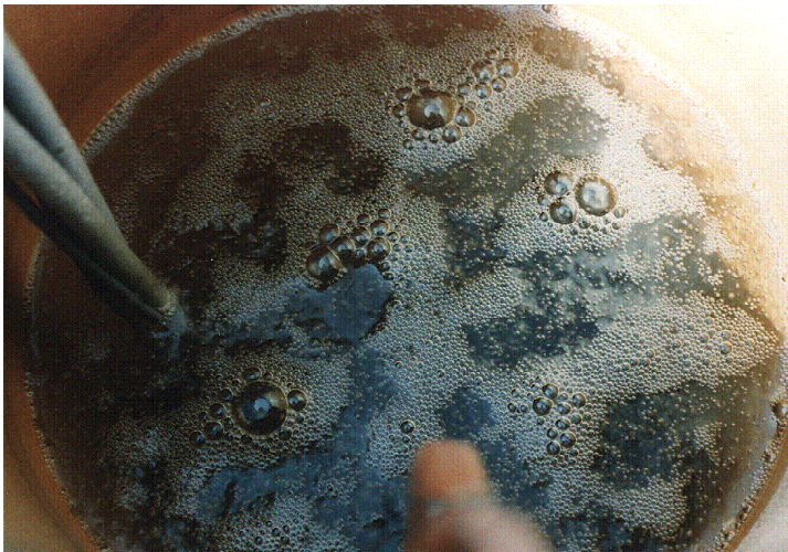
Abb. 3b: Blasenbild bei mit Salz versetztem Trinkwasser
